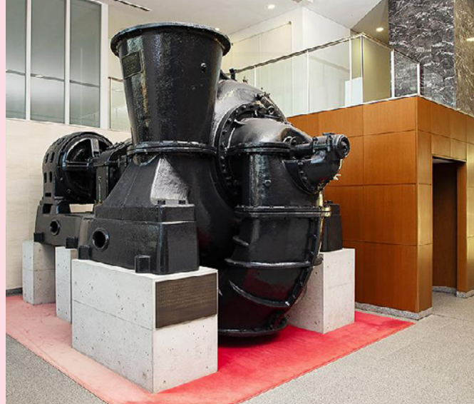
▲1921年に完成したポンプで、今は本社一階に展示されています。当時はほぼ手作業でこれを完成させたそうです。高さ、幅ともに3m以上あります。その大きさにはいつも圧倒されます。
